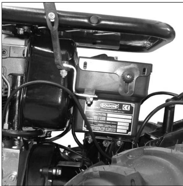
Das Metallschild befindet sich auf dem Deckel des Zubehörkastens.
