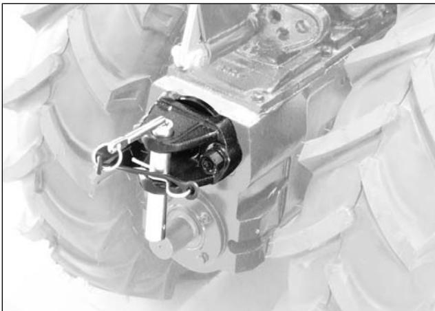
Die Maschine kann für die Benutzung mit kleinen Anhängern oder Brühebehältern mit einer Anhängekupplung versehen werden.
