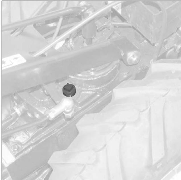
Den Ölstand mit dem Ölmessstab (MIND.-MAX.) prüfen
