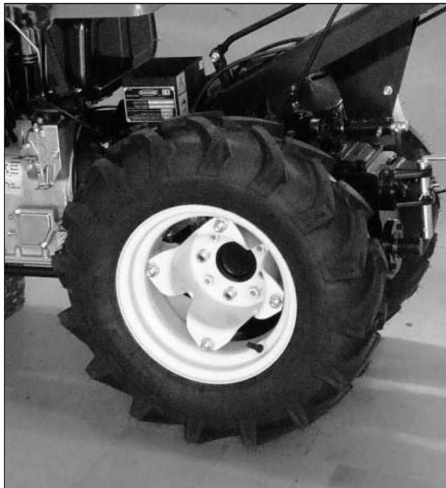
Möglichkeit zum Verändern der Spurweite der Räder, indem man die Radscheibe auf dem Flansch verschiebt.
