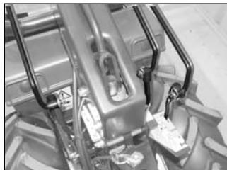
Die Stange montieren **① ② ③** und mit den Splinten blockieren
