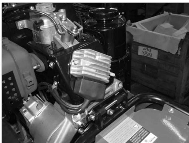
Zum Starten des Motors sollte man das Schaltgetriebe und die Zapfwelle in die neutrale Stellung bringen und den Gear Stop Hebel ① gehoben halten, damit die Kupplung ausgeschaltet ist.
