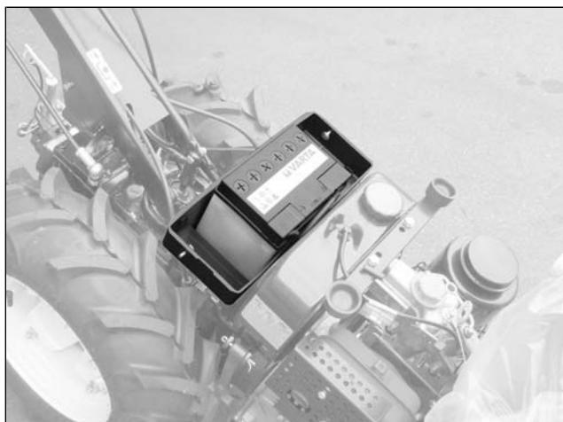
Zum Zugriff auf die Batterie, die Haube öffnen und den Schutz ausbauen, durch Entfernen der seitlichen Knöpfe (Abbildung 1)
